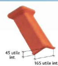
Faîtière / arêtier angulaire à emboîtement pour pose bâtie (2,3 au ml) Réf. 208.150
