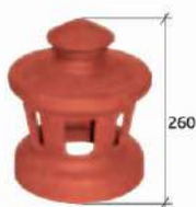
Lanterne ø 150 (section d'aération : 165 cm 2 ) Réf. 1009
