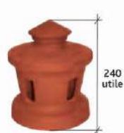
Lanterne ø 120 utile (section d'aération : 140 cm 2 ) Réf. 1011
